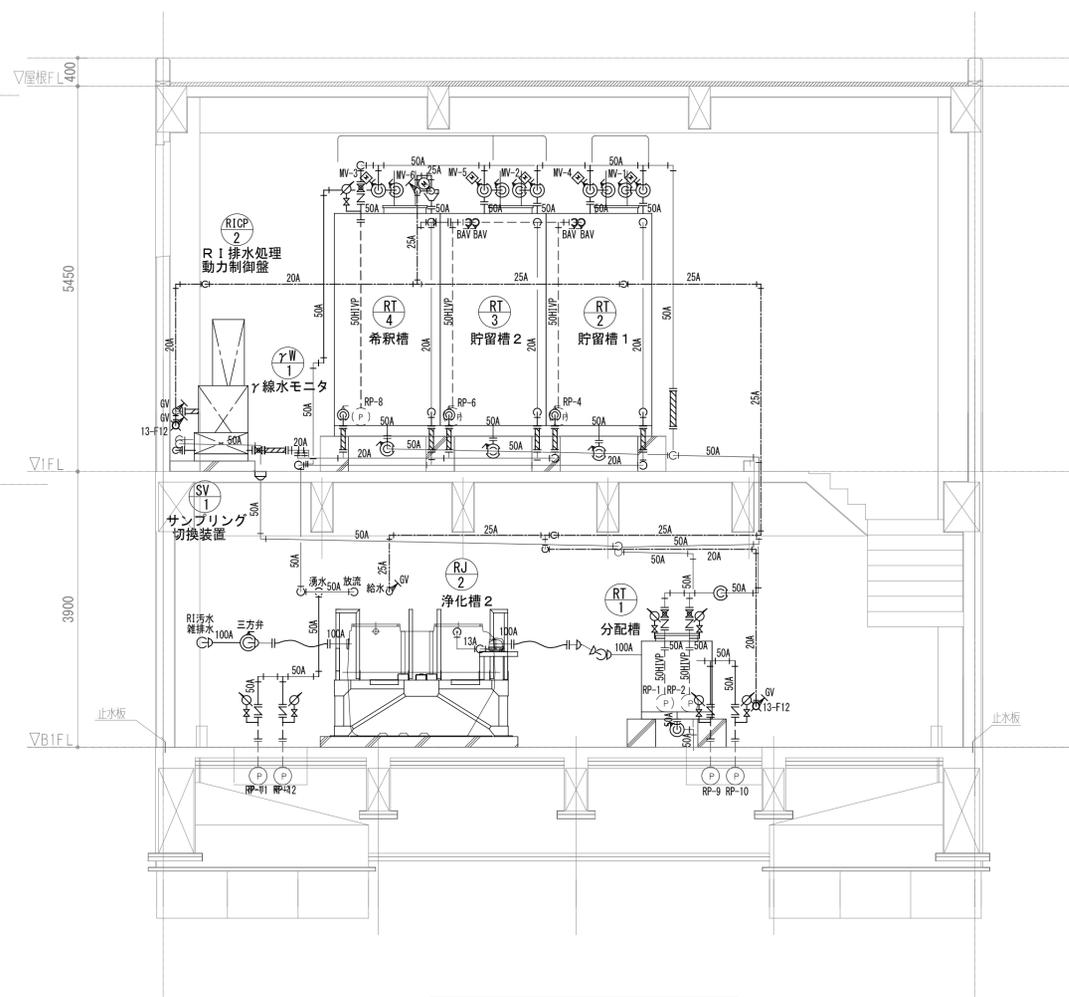
R I 排水処理設備 A-A断面図
